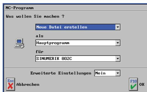
In der Betriebsart 'Simulator' werden Sie von einem Startassistenten empfangen und schnell zur eigentlichen Eingabe geführt. Besonders bei der Neuerstellung einer Datei nimmt er Ihnen viel Arbeit ab, da er die Voreinstellungen für die Betriebsart mit Ihren Eingaben kombiniert und anschließend die neue Datei zum Bearbeiten bereitstellt.
