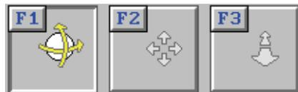
Mit diesen Funktionen kann man das angezeigte Bild im 3D-Raum rotieren <F1>, positionieren <F2> und in der Größe verändern <F3> .
