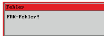
So führen beispielsweise Innenradien, die kleiner oder gleich dem Werkzeugradius sind, zu einer Fehlermeldung.
