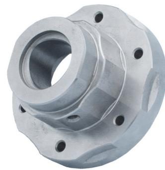
Hier sehen Sie das Fräsen einer Schlüsselfläche auf der Stirnseite des Werkstückes und eine gefräste Führungsnut auf der Mantelfläche.
