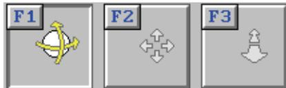
Mit diesen Funktionen kann man das angezeigte Bild im 3D-Raum rotieren <F1>, positionieren <F2> und in der Größe verändern <F3> .
