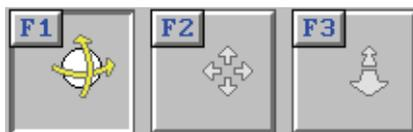
Die 3D-Ansicht erfordert besondere Funktionalitäten der Lupe. So werden Funktionen benötigt, um das angezeigte Werkstück im 3D-Raum rotieren <F1>, positionieren <F2> und in der Größe verändern <F3> zu können.
