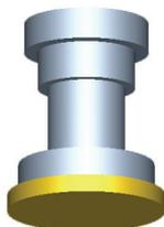
Wenn Sie die Funktion <F3> 'Werkzeug' aufrufen, wird Ihnen das Werkzeug so angezeigt, wie es die Software intern für die Verfahrswegs- und Werkstückmodell-Berechnung betrachtet. Es handelt sich hierbei immer nur um zylindrische Körper, d.h., am Werkzeug vorhandene Rundungen oder schräge Kanten erzeugen in der 3D-Ansicht und im internen Modell des Werkstücks nur rechtwinklige Werkstück-Kanten.
