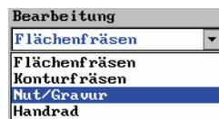
Die Maus bietet mittels Klick bzw. Doppelklick die "einfachste" Methode zum Öffnen der Auswahlliste und zum Auswählen der Option in der blauen Fläche. Die Auswahlliste kann auch mit der Taste <F9> angezeigt werden. Die gewünschte Option wird dann mit den <Pfeiltasten> ausgewählt und anschließend mit der Taste <Enter> übernommen.
