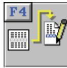
Wenn der Cursor auf einer Zeile mit einem Unterprogramm-Aufruf (z.B: **SUB01**) steht, können Sie mit <F4> 'Öffnen' das Unterprogramm zum Ändern aufrufen. Dadurch wird ein bestehendes (oder neues) Unterprogramm zum Editieren - parallel zum gerade aktiven Hauptprogramm - geöffnet.
