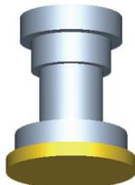
Wenn Sie die Funktion <F3> 'Werkzeug' aufrufen, wird Ihnen das Werkzeug so angezeigt, wie es die Software intern für die Verfahrenswegs- und Werkstückmodell-Berechnung betrachtet. Es handelt sich hierbei immer nur um zylindrische Körper, d.h., am Werkzeug vorhandene Rundungen oder schräge Kanten erzeugen in der 3D-Ansicht und im internen Modell des Werkstücks nur rechtwinklige Werkstück-Kanten.
